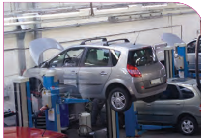
Görsel 4.2: Kaldırıcı (lift) yardımıyla yüksektirilmiş otomobil
